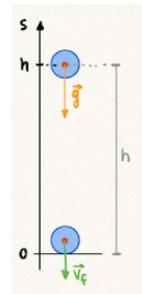
Il grafico velocità tempo, ovvero la rappresentazione grafica della legge della velocità, è invece una retta decrescente che parte nell'origine perché la velocità iniziale è nulla, termina nel punto di ordinata  $v_f$  e ha come coefficiente angolare l'accelerazione del moto  $-g$ .
